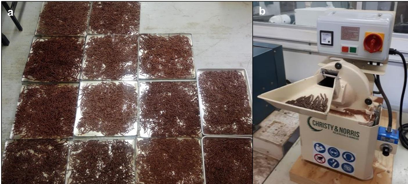
**Figura 11.** a) extrudidos secos, b) disminución de tamaño de partícula de los extrudidos en un molino de martillo.
