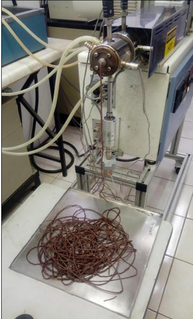
**Figura 10.** Extrusor de un solo tornillo utilizado para la obtención de salvado de sorgo extrudido.
